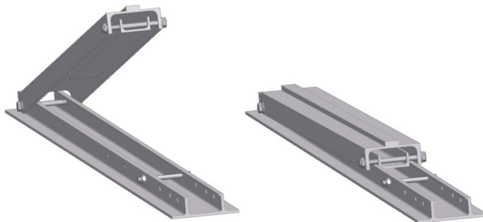
Bild 4.5: Ineinanderklappen der Winkelstütze
