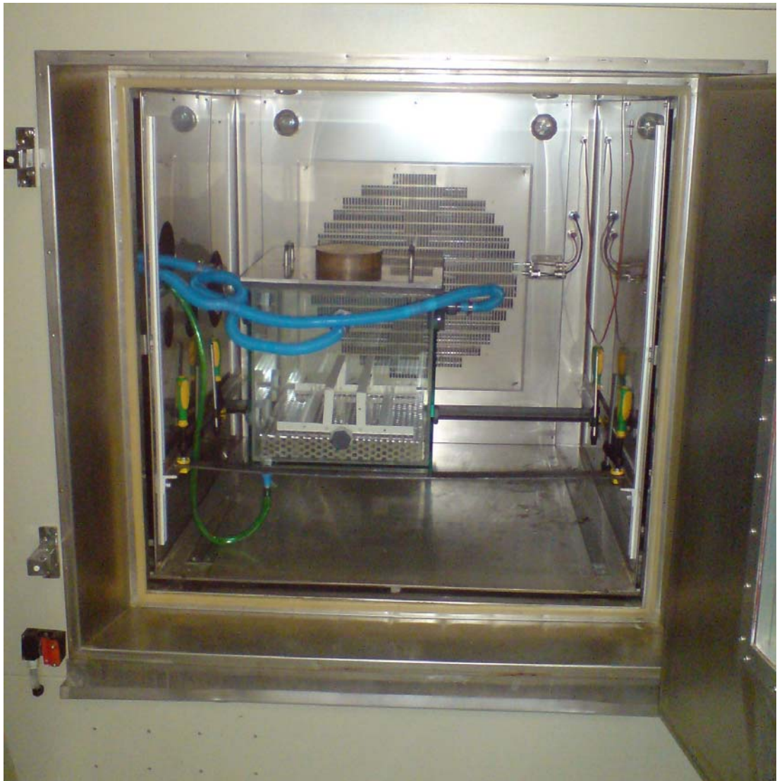
Abbildung A-21: Prüfkammer mit Verschlussystem und Probehalter in Klimakammer
