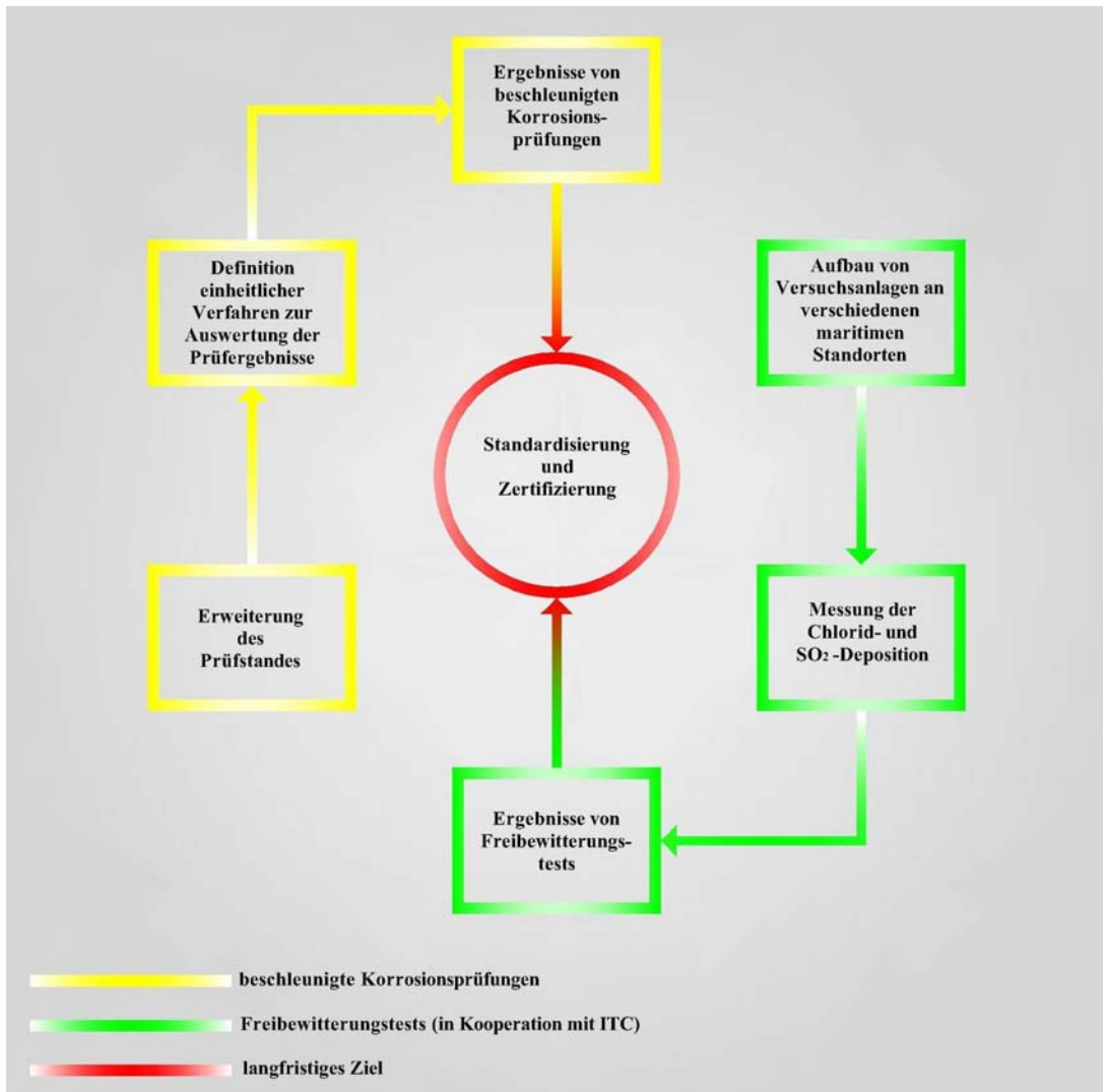
Abbildung 8-1: Weitere Vorgehensweise zur Entwicklung eines zertifizierten Prüfverfahrens
