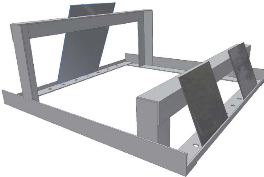
Abbildung 5-6: Probenhalter mit zwei Proben 50*50\text{mm}^2 und einer Probe 100*70\text{mm}^2
