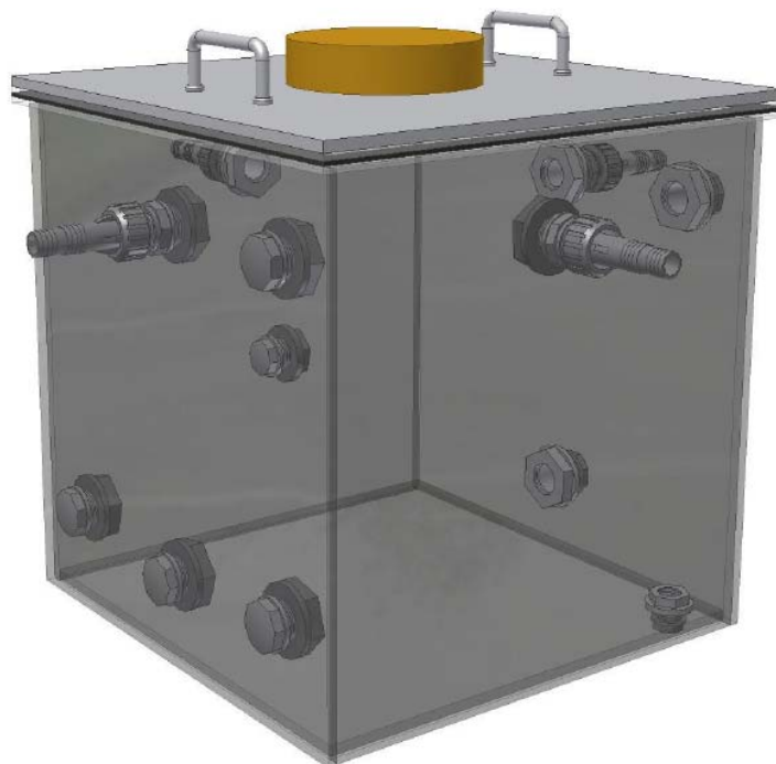
Abbildung 5-5: Prüfkammer mit allen Anschlüssen und dem Verschlussystem
