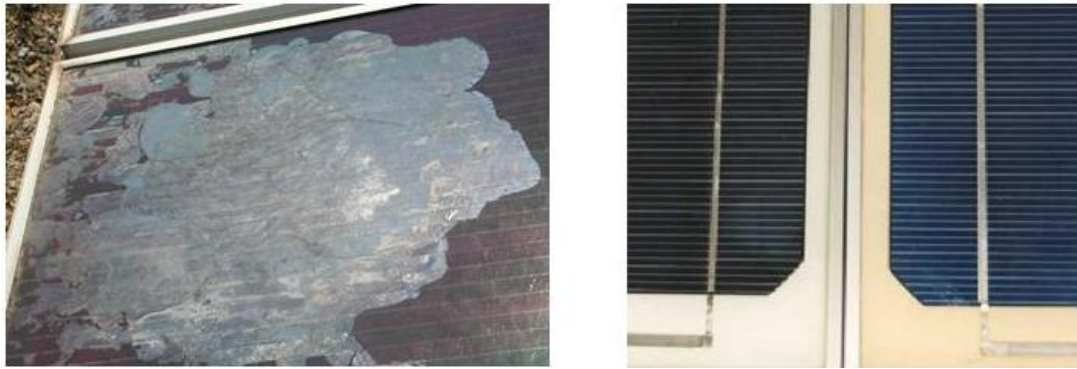
Abbildung 2-11: Delamination und Browning des Einkapselungspolymeres von PV-Modulen
