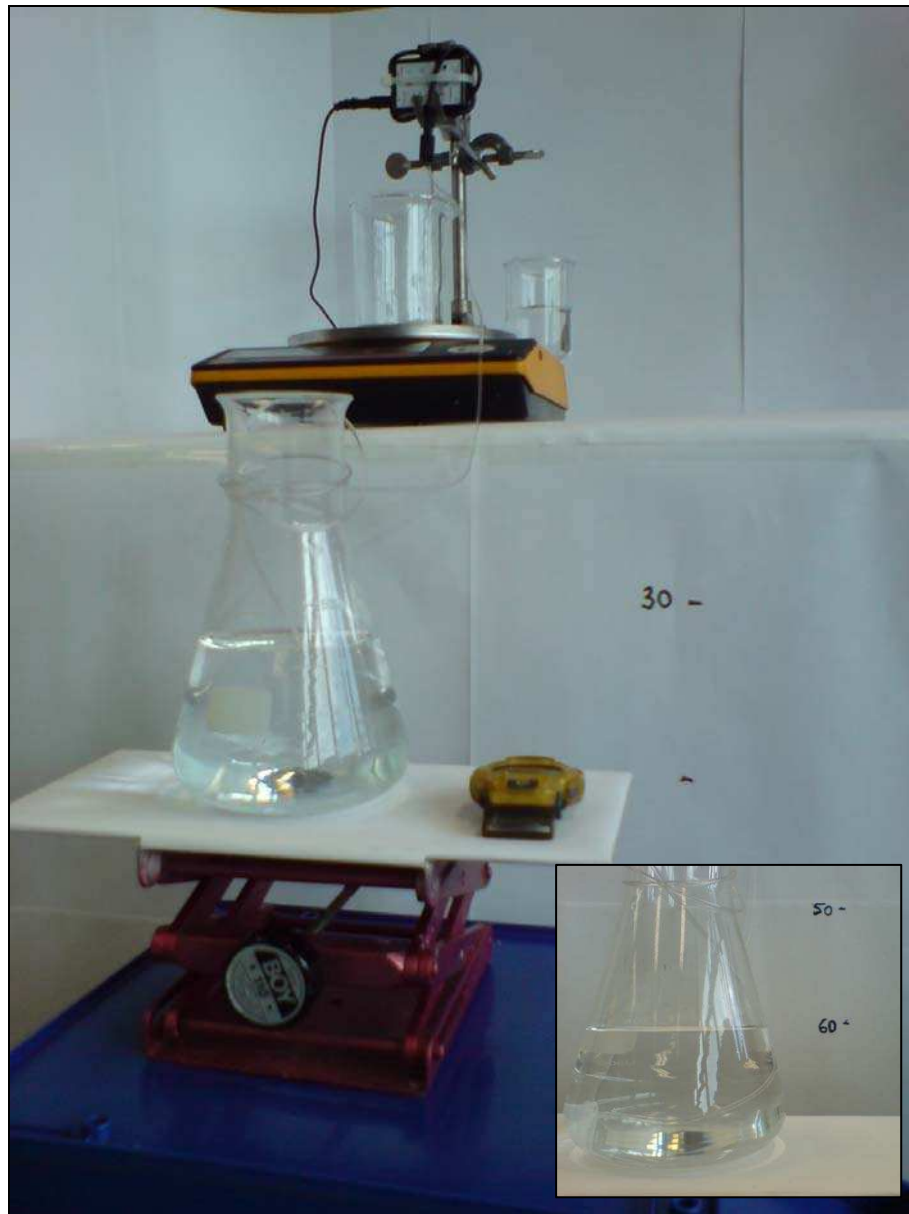
Abbildung A.13: Messaufbau zur Bestimmung der Volumenstromänderung bezogen auf die Ansaughöhe
