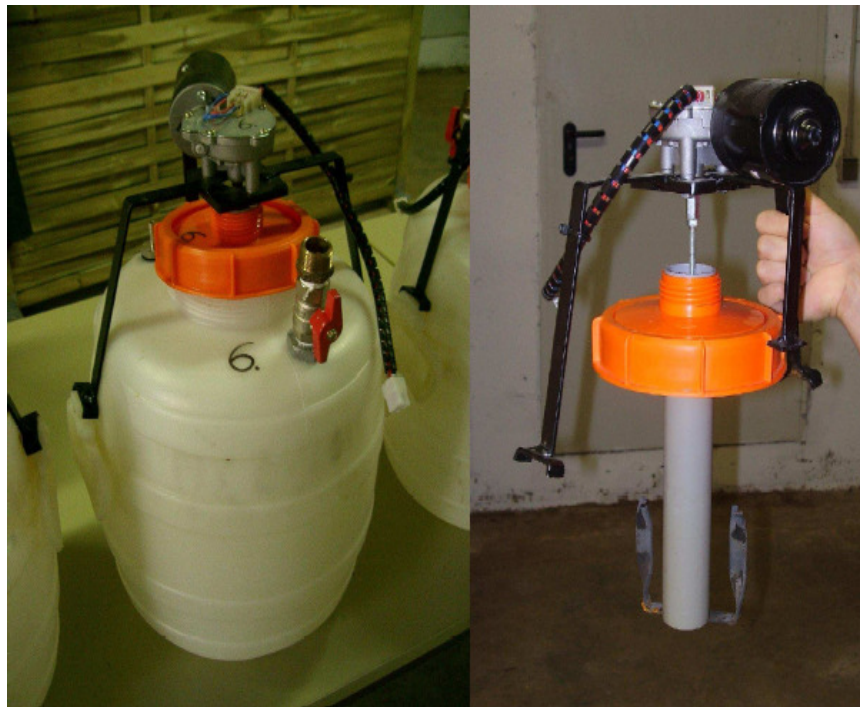
Abbildung 3.8: 20-l-Versuchsreaktor mit U-förmigem Rührwerk
