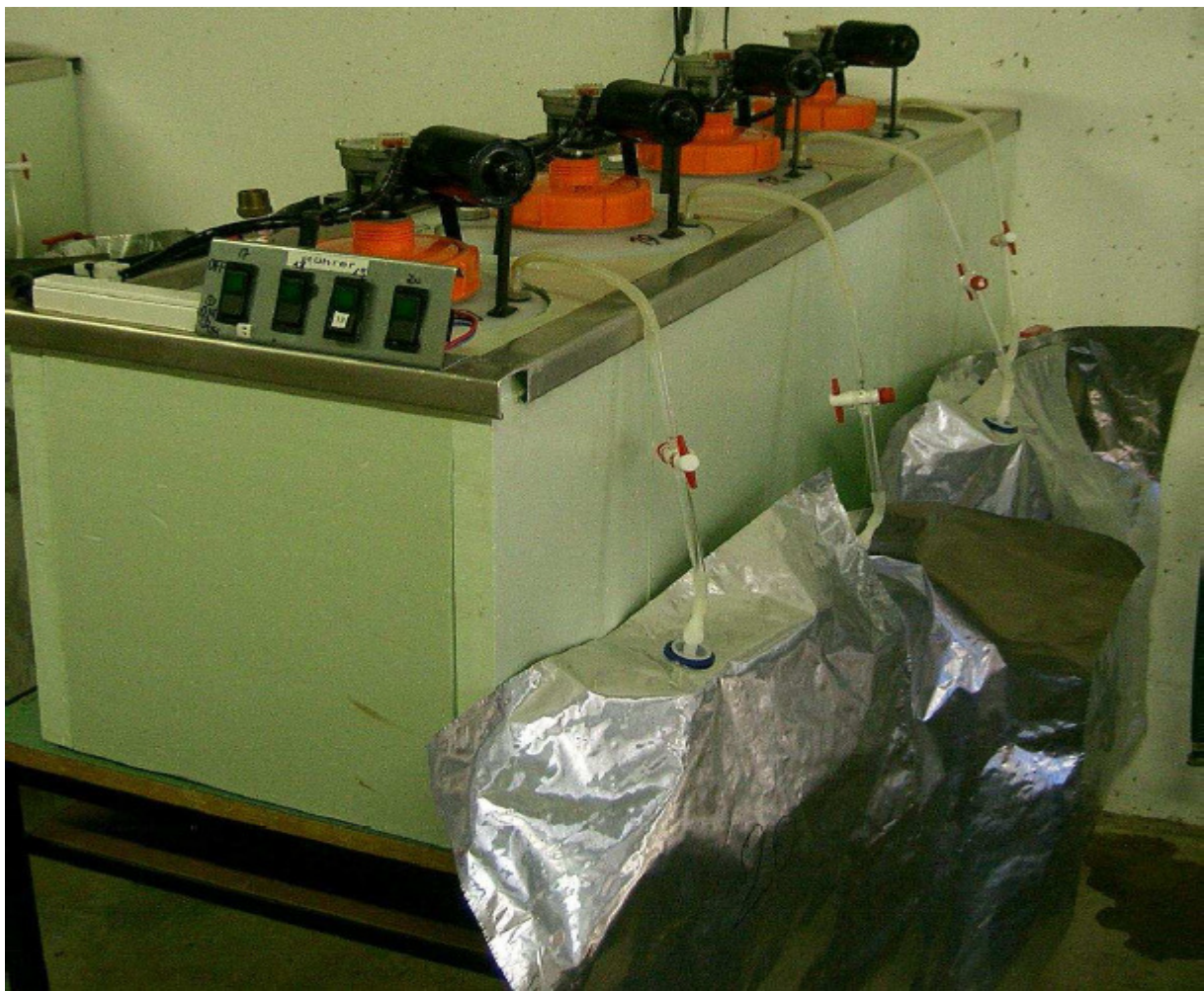
Abbildung 3.9: Versuchsreaktoren mit Gasauffangbeuteln im Wasserbad
