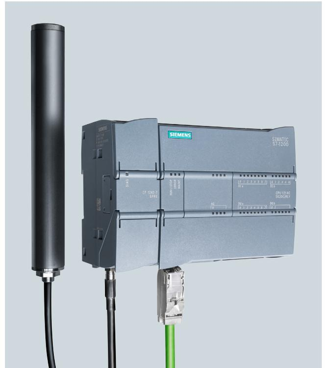
Die beiden RTUs (Remote Terminal Units) in Nicaragua bestehen aus jeweils einer Steuerung SIMATIC S7-1200 mit Kommunikationsprozessor CP 1242-7. Die vor Ort erfassten Messwerte werden über GPRS direkt in die „Leitstelle“ der Hamburger Schule übertragen.
