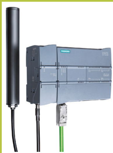
03 Die beiden RTUs (Remote Terminal Units) in Nicaragua bestehen aus jeweils einer Steuerung Simatic S7-1200 mit Kommunikationsprozessor CP 1242-7; die erfassten Messwerte werden über GPRS direkt in die „Leitstelle“ der Hamburger Schule übertragen
